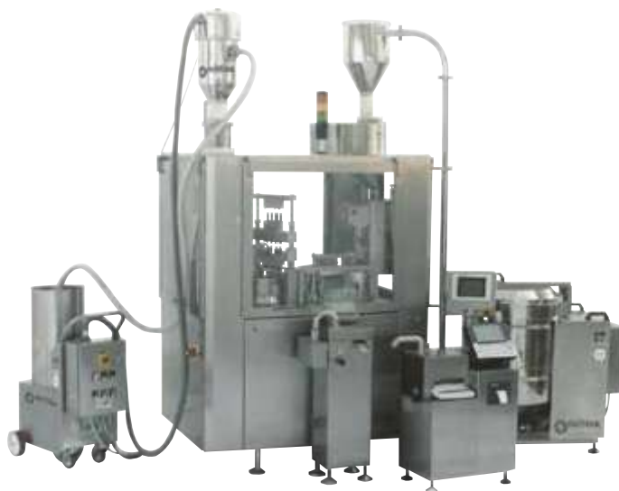
Transportador pneumático (esquerdo) e empurrador de cápsulas (direito), em uma empresa farmacêutica.
